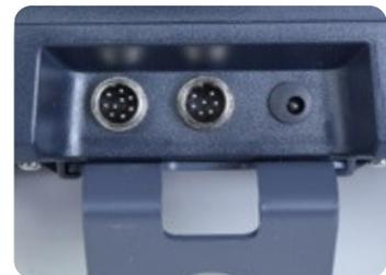
Conexión indicador plataforma y alimentador de corriente.
